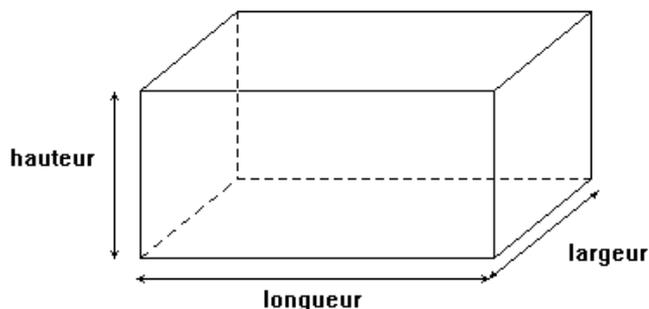
$$\text{Volume} = \text{Longueur} \times \text{largeur} \times \text{hauteur}$$
